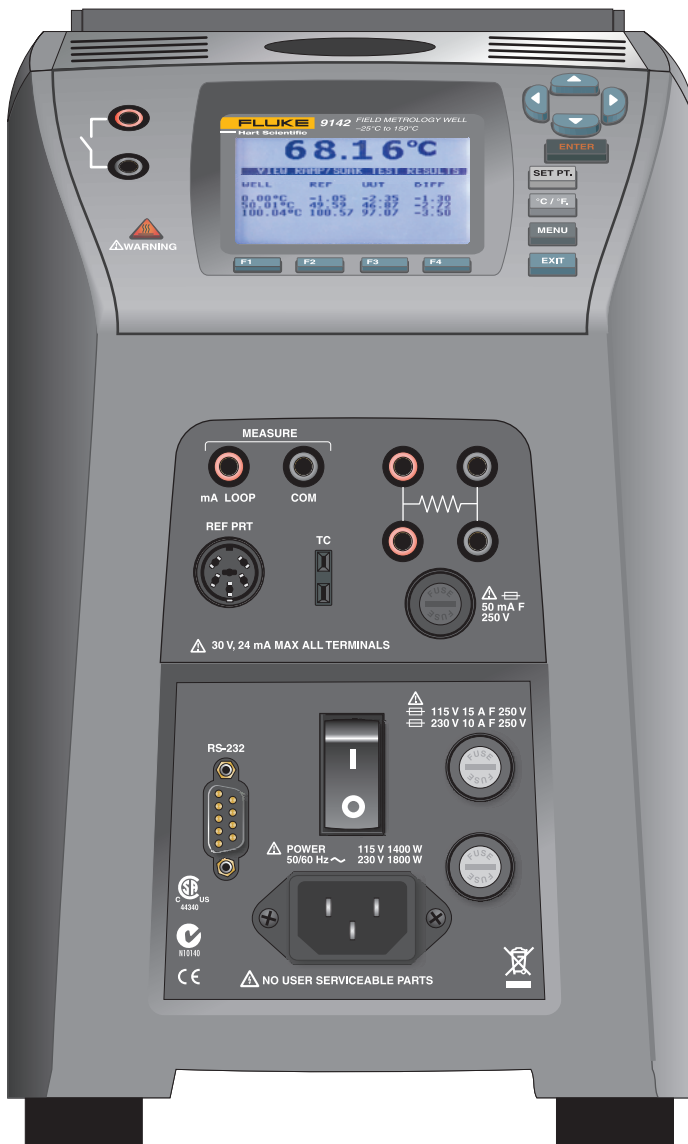
Figure 2 Puits de métrologie de terrain 914X
